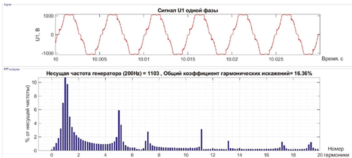
Рис. 2. Гармонический состав на статоре генератора с использованием активного выпрямителя
